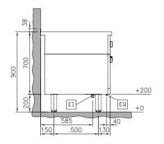
Electrical inlet (power) Equipotential screw
